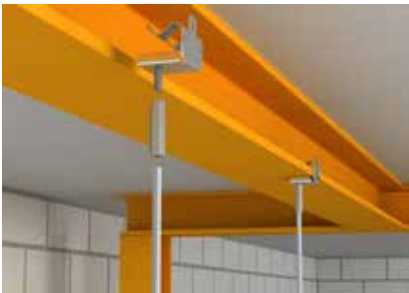
Clip con perno filettato per l'installazione di aste filettate
